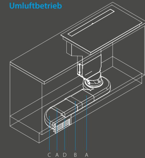
Durch den Einsatz eines passenden Flachkanalsystems wird die Luft optimal aus dem Korpus geführt.
